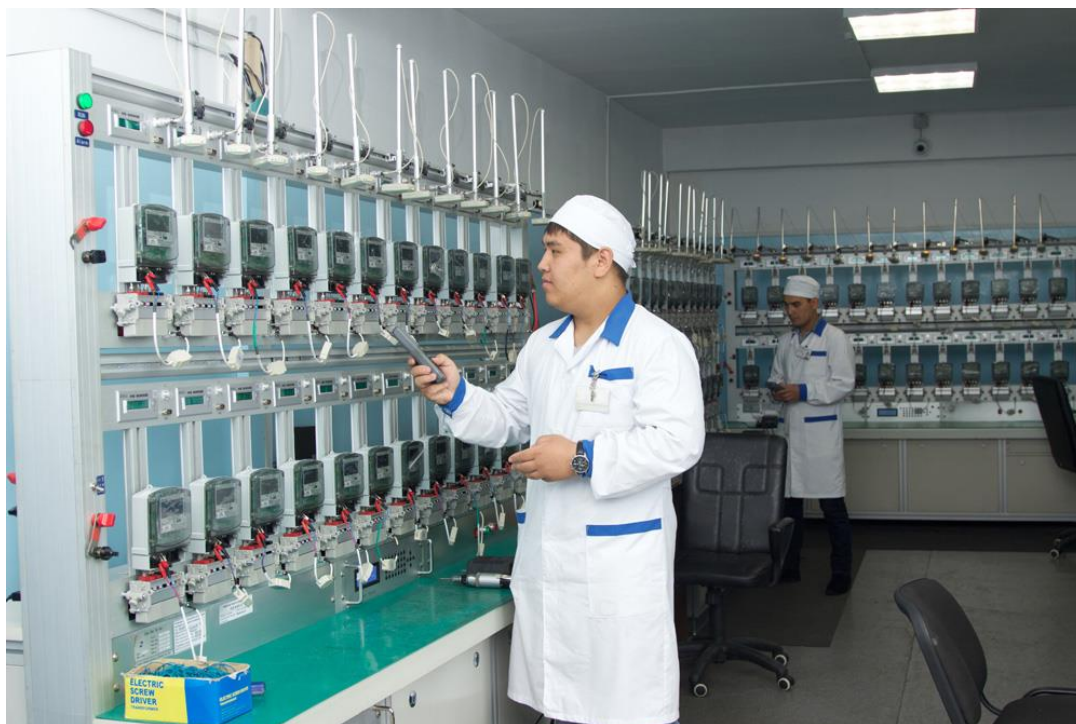
6-сурет - Электр есептегіштерді тексеруге арналған жоғары технологиялық жабдықталған сынақ орталығы[14]
